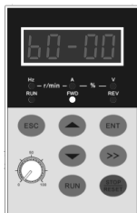
Fig. 4-2 Visualización Parámetro Primer Nivel (Parámetro "b0-00")
