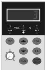
Fig. 4-3 Visualización Parámetro Segundo Nivel ("3" es el valor de "b0-00")
